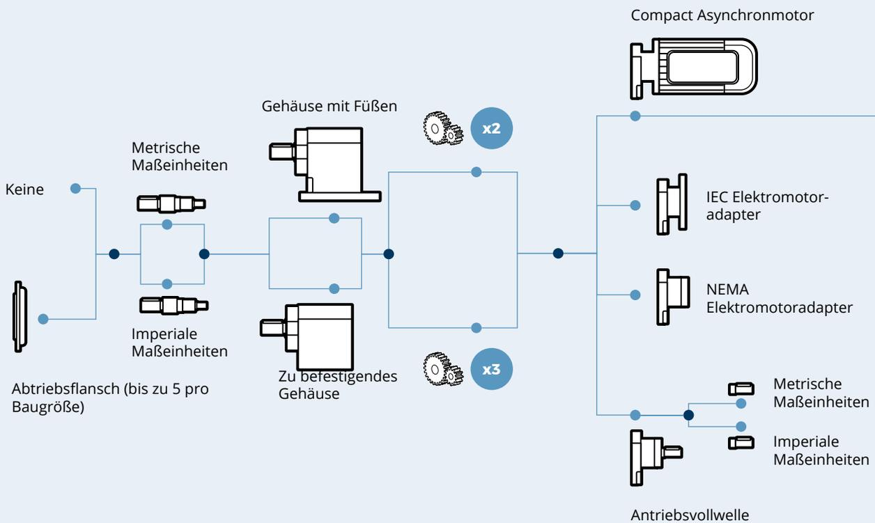
Konfigurationen mit Füßen und Flansch verfügbar
